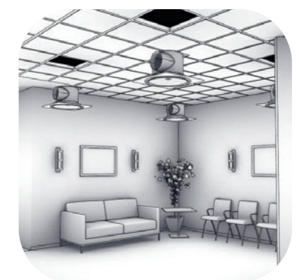
Installation en lieu et place d'une dalle de plafond standard
