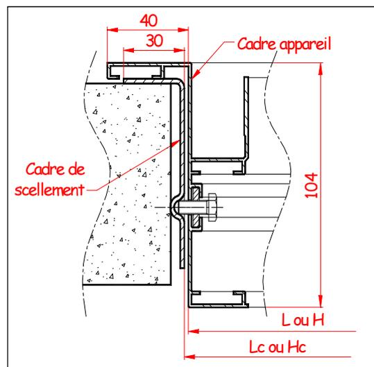
6 - Présenter l'OXYTONE LAMES 2013 dans le cadre de scellement, puis brider l'ensemble à l'aide des vis de blocage.
