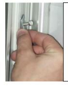
4 Placer les inserts avec les vis dans la rainure du profil.
